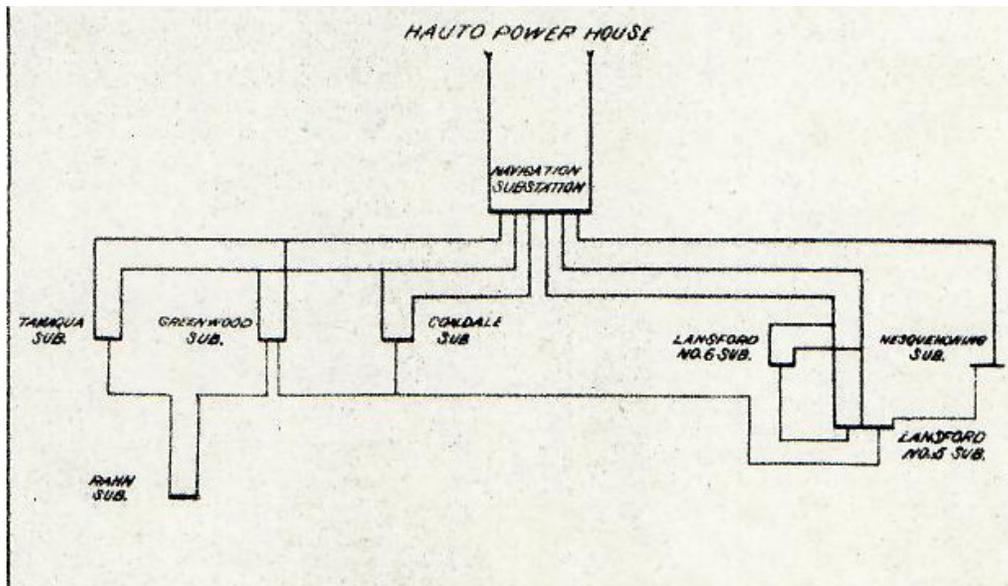
Figure 1 LNC 11,000 volt distribution system<sup>7</sup> (Single Line Diagram)
